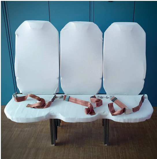
Bild 5. Die innere Sitzschale wird im WCM-Verfahren gefertigt. © Fraunhofer ICT
