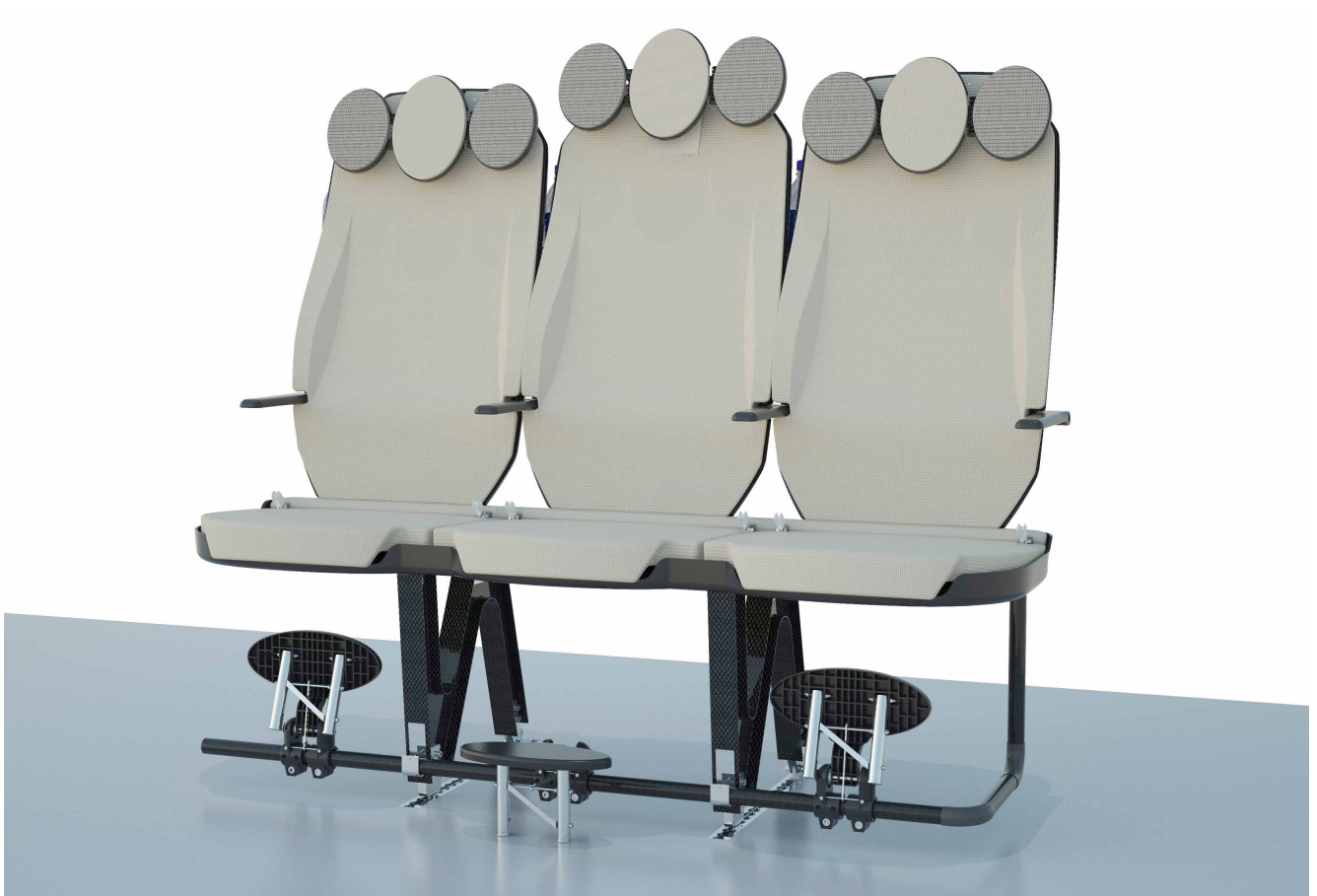
Monomaterial-Flugzeugsitze, hergestellt in Leichtbauweise, verringern den CO 2 -Abdruck um etwa 20%. © Fraunhofer ICT
